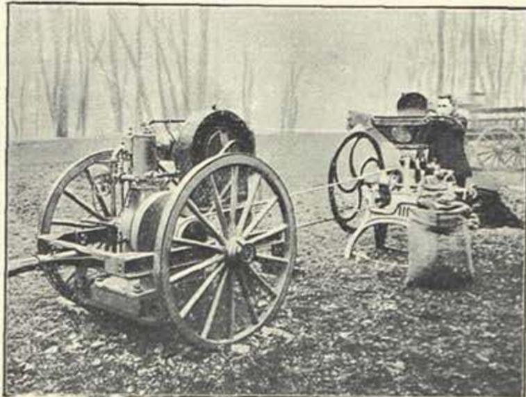
Motor agrícola montado sobre un carrito de dos ruedas y haciendo funcionar un molino de granos.
