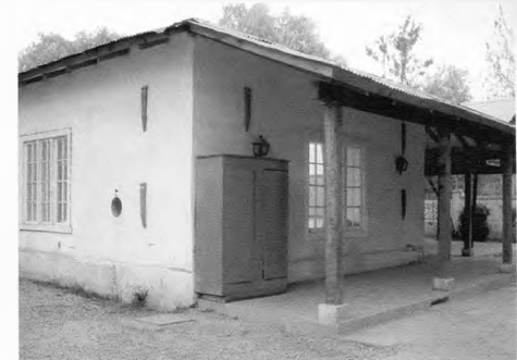
Escuela de la Araya, Pirque; muro de sáboe de 60 cm de espesor
